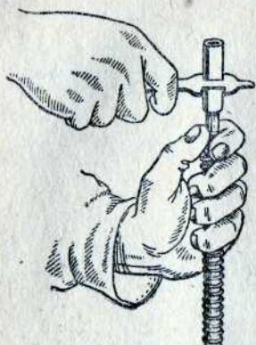
Рис. 35. Отделение газового поршня
