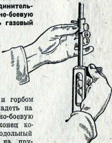
Рис. 39. Надевание соединительной муфты
