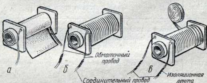
Рис. 81. Изготовление катушки электромагнита: а — изоляция слоев бумагой; б — сращивание соединительного и обмоточного проводов; в — изоляция обмотки изоляционной лентой.
