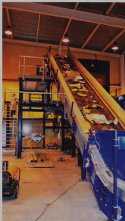
Подача мусора в баллистический сепаратор
